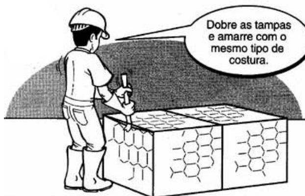
Figura 3.9 – Detalhe da etapa de fechamento do gabião tipo caixa.
