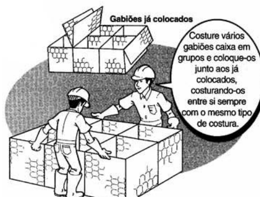
Figura 3.4 – Posicionamento dos gabiões antes de seu enchimento.
