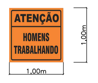
PLACAS DE IDENTIFICAÇÃO PLACA PROVISÓRIA (OT=02 UN)
