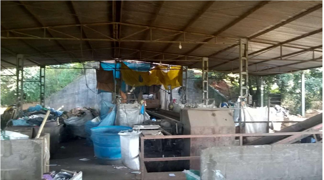
Foto 4 – Apresenta baias para armazenagem dos materiais e esteira de transporte dos resíduos.
